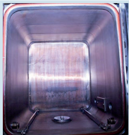
Abbildung 2: Zustand einer Kammer nach mehrfacher Nutzung (sichtbar verfärbte Kammer) (Quelle: Belimed)
