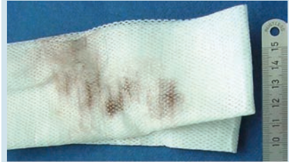
Abbildung 9: Abwischprobe einer rougingbehafteten Edelstahloberfläche [6]
